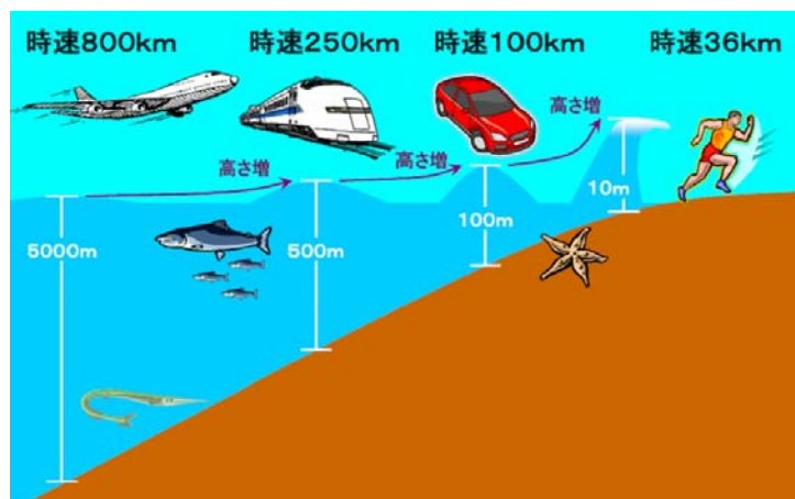
図-3.3 海底の深さと津波の速度・波高の関係の概念図
